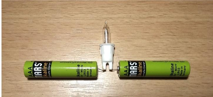
Abbildung 13: Offener Stromkreis (es fließt kein Strom)
