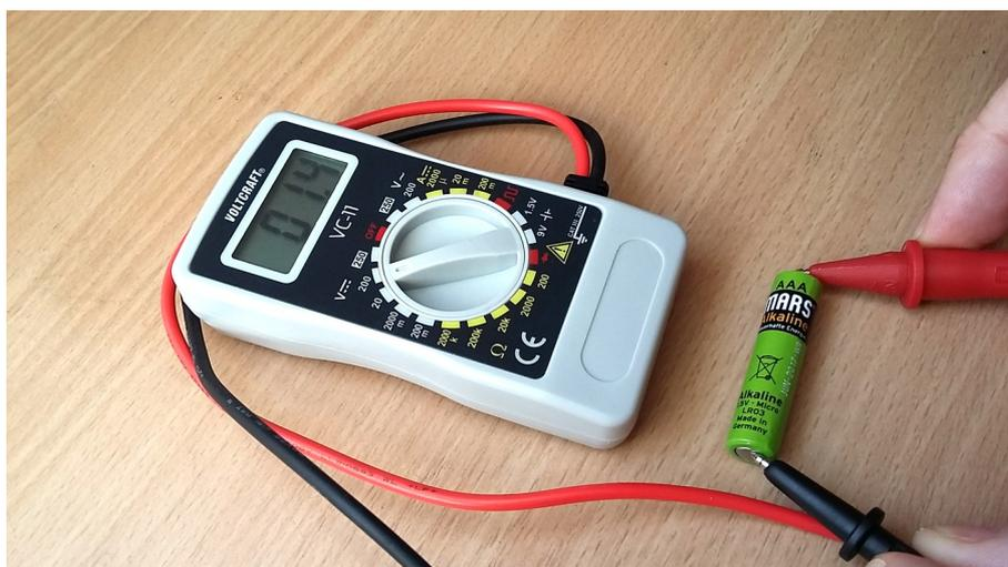
Abbildung 8: Messung der Spannung einer Batterie
